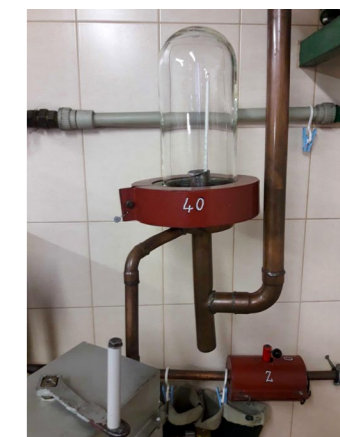
Epruveta – obvyklé umístění lihoměru v pálenici
