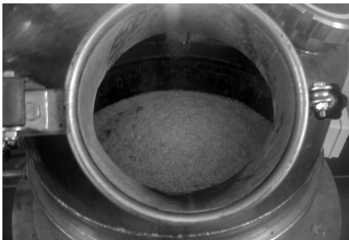
Obr. 1, 2 Pěnivost snižená po použití odpěňovače již není pro dobře konstruované kotle problémem.
